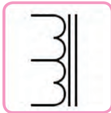
Sumber : Dokumen Kemdikbud Gambar 2.13 . Simbol autotransformator
