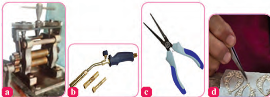
Gambar 1.23. Plat kerajinan logam; a. Alat penggiling logam menjadi plat, b. alat patri, c. tang lancip, d. penjepit.
