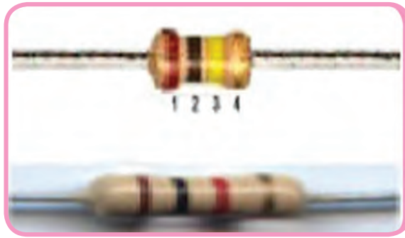
Gambar 2.4. Resistor dengan 4 gelang dan 5 gelang warna
